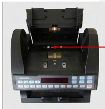
Mit dem neuen STC-Sensor wird der auf dem Sicherheitsfaden aufbrachte Magnetcode dekodiert, darüber der Notenwert ermittelt und gleichzeitig die Echtheit der Note geprüft.
